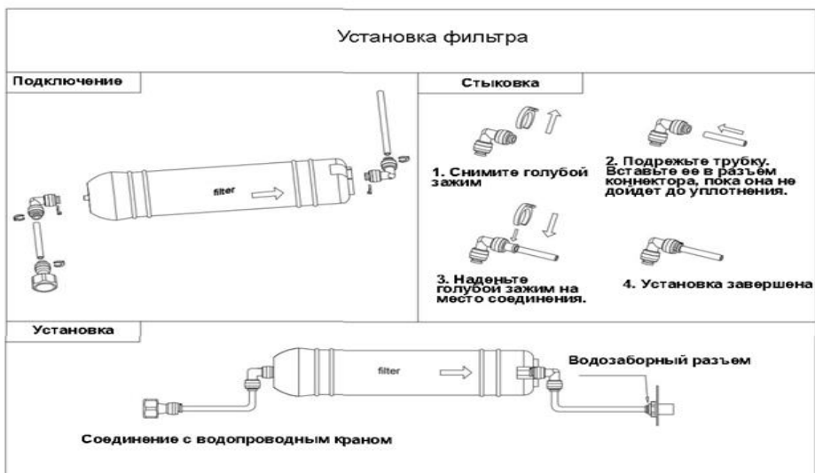
Рис.1 Схема подключению к водоснабжению.
